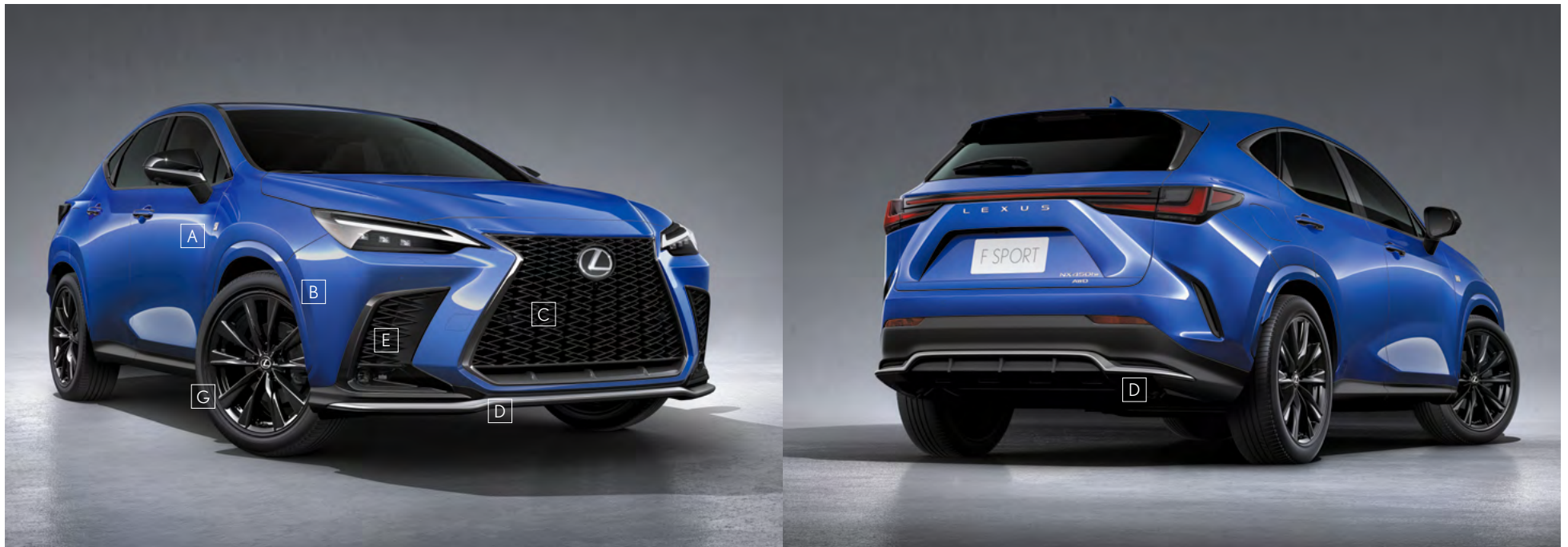
A_Logo F SPORT / B_Ốp viền hốc nắp / C_Lưới tản nhiệt / D_Ốp hướng gió bên dưới cản / E_Ốp trang trí / G_Mâm xe hợp kim nhôm 20 inch độc quyền
